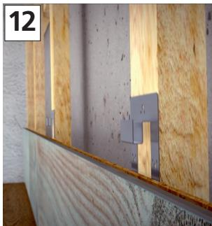
Панели на уровне 3 можно крепить профильными захватами 3D. На каждой планке при этом должен быть смонтирован профильный захват. Профильные захваты устанавливаются таким образом, чтобы открытая сторона корпуса захвата была обращена вверх. Фиксация уровня 3 происходит за счет примыкающих сверху и снизу рядов панелей [13].
